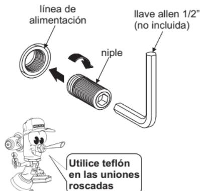
3 Enrosque la salida armada en el conector hasta lograr su posición correcta.
