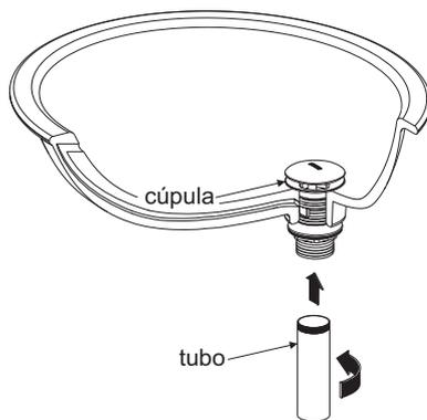
Coloque teflón y apriete firmemente para evitar filtraciones.
