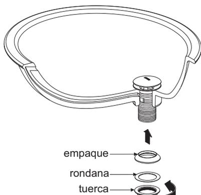
Apriete firmemente la tuerca para evitar filtración de agua.
