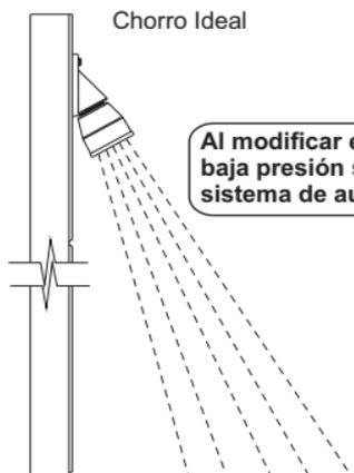
Al modificar el sistema a baja presión se inhabilita el sistema de autolimpieza.
